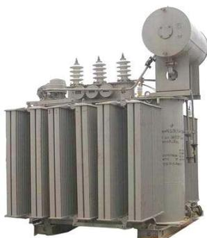
Трансформаторы ТМ трехфазные, двухобмоточные, масляные, с естественным масляным охлаждением, с переключением ответвлений без возбуждения (ПБВ), с диапазоном регулирования  $\pm 2 \times 2,5\%$ , предназначены для преобразования напряжения в сетях 35 кВ.
